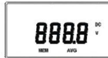
En mode d'enregistrement (ou lorsque le multimètre affiche la valeur maximale ou minimale), appuyez sur le bouton MEM pendant plus d'une seconde pour que le multimètre quitte le mode d'enregistrement.
